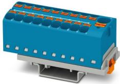
Verteilerblock, Nennspannung: 800 V, Nennstrom: 32 A, Anzahl der Anschlüsse: 19, Anschlussart: Push-in-Anschluss, Bemessungsquerschnitt: 4 mm<sup>2</sup>, Abgriff, Querschnitt: 0,2 mm<sup>2</sup> - 6 mm<sup>2</sup>, Push-in-Anschluss, Sammelanschluss, Bemessungsquerschnitt: 10 mm<sup>2</sup>, Querschnitt: 0,5 mm<sup>2</sup> - 10 mm<sup>2</sup>, Montageart: NS 35/7,5, NS 35/15, Farbe: blau
