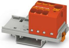
Verteilerblock, Nennspannung: 800 V, Nennstrom: 32 A, Anzahl der Anschlüsse: 7, Anschlussart: Push-in-Anschluss, Bemessungsquerschnitt: 4 mm<sup>2</sup>, Abgriff, Querschnitt: 0,2 mm<sup>2</sup> - 6 mm<sup>2</sup>, Push-in-Anschluss, Sammelanschluss, Bemessungsquerschnitt: 10 mm<sup>2</sup>, Querschnitt: 0,5 mm<sup>2</sup> - 10 mm<sup>2</sup>, Montageart: NS 35/7,5, NS 35/15, Farbe: rot
