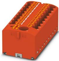
Verteilerblock, Grundklemme mit Einspeisung, Nennspannung: 450 V, Nennstrom: 24 A, Anzahl der Anschlüsse: 19, Anschlussart: Push-in-Anschluss, Bemessungsquerschnitt: 2,5 mm<sup>2</sup>, Abgriff, Querschnitt: 0,14 mm<sup>2</sup> - 4 mm<sup>2</sup>, Push-in-Anschluss, Sammelschluss, Bemessungsquerschnitt: 6 mm<sup>2</sup>, Querschnitt: 0,5 mm<sup>2</sup> - 10 mm<sup>2</sup>, Montageart: kleben, Farbe: rot
