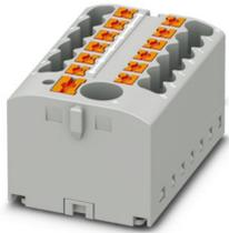
Verteilerblock, Grundklemme mit Einspeisung, Nennspannung: 450 V, Nennstrom: 24 A, Anzahl der Anschlüsse: 13, Anschlussart: Push-in-Anschluss, Bemessungsquerschnitt: 2,5 mm<sup>2</sup>, Abgriff, Querschnitt: 0,14 mm<sup>2</sup> - 4 mm<sup>2</sup>, Push-in-Anschluss, Sammelschluss, Bemessungsquerschnitt: 6 mm<sup>2</sup>, Querschnitt: 0,5 mm<sup>2</sup> - 10 mm<sup>2</sup>, Montageart: kleben, Farbe: grau
