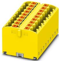
Verteilerblock, Grundklemme, Nennspannung: 450 V, Nennstrom: 24 A, Anzahl der Anschlüsse: 18, Anschlussart: Push-in-Anschluss, Querschnitt: 0,14 mm<sup>2</sup> - 4 mm<sup>2</sup>, Montageart: kleben, Farbe: gelb
