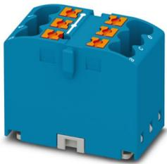
Verteilerblock, Grundklemme, Nennspannung: 450 V, Nennstrom: 24 A, Anzahl der Anschlüsse: 6, Anschlussart: Push-in-Anschluss, Querschnitt: 0,14 mm<sup>2</sup> - 4 mm<sup>2</sup>, Montageart: kleben, Farbe: blau
