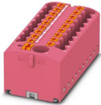
Verteilerblock, Grundklemme mit Einspeisung, Nennspannung: 450 V, Nennstrom: 24 A, Anzahl der Anschlüsse: 19, Anschlussart: Push-in-Anschluss, Bemessungsquerschnitt: 2,5 mm<sup>2</sup>, Abgriff, Querschnitt: 0,14 mm<sup>2</sup> - 4 mm<sup>2</sup>, Push-in-Anschluss, Sammelschluss, Bemessungsquerschnitt: 6 mm<sup>2</sup>, Querschnitt: 0,5 mm<sup>2</sup> - 10 mm<sup>2</sup>, Montageart: aufrasten auf Tragschienenadapter, Direktmontage mit Flansch, Fliegend, Farbe: pink
