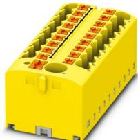
Verteilerblock, Grundklemme mit Einspeisung, Nennspannung: 450 V, Nennstrom: 24 A, Anzahl der Anschlüsse: 19, Anschlussart: Push-in-Anschluss, Bemessungsquerschnitt: 2,5 mm<sup>2</sup>, Abgriff, Querschnitt: 0,14 mm<sup>2</sup> - 4 mm<sup>2</sup>, Push-in-Anschluss, Sammelanschluss, Bemessungsquerschnitt: 6 mm<sup>2</sup>, Querschnitt: 0,5 mm<sup>2</sup> - 10 mm<sup>2</sup>, Montageart: aufrasten auf Tragschienenadapter, Direktmontage mit Flansch, Fliegend, Farbe: gelb
