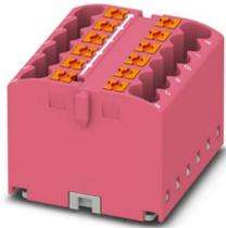
Verteilerblock, Grundklemme, Nennspannung: 450 V, Nennstrom: 24 A, Anzahl der Anschlüsse: 12, Anschlussart: Push-in-Anschluss, Querschnitt: 0,14 mm<sup>2</sup> - 4 mm<sup>2</sup>, Montageart: aufrasten auf Tragschienenadapter, Direktmontage mit Flansch, Fliegend, Farbe: pink
