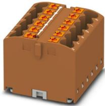
Verteilerblock, Grundklemme, Nennspannung: 450 V, Nennstrom: 24 A, Anzahl der Anschlüsse: 12, Anschlussart: Push-in-Anschluss, Querschnitt: 0,14 mm<sup>2</sup> - 4 mm<sup>2</sup>, Montageart: aufrasten auf Tragschienenadapter, Direktmontage mit Flansch, Fliegend, Farbe: braun
