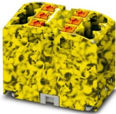
Verteilerblock, Grundklemme, Nennspannung: 450 V, Nennstrom: 24 A, Anzahl der Anschlüsse: 6, Anschlussart: Push-in-Anschluss, Querschnitt: 0,14 mm<sup>2</sup> - 4 mm<sup>2</sup>, Montageart: aufrasten auf Tragschienenadapter, Direktmontage mit Flansch, Fliegend, Farbe: schwarz/gelb
