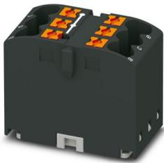
Verteilerblock, Grundklemme, Nennspannung: 450 V, Nennstrom: 24 A, Anzahl der Anschlüsse: 6, Anschlussart: Push-in-Anschluss, Querschnitt: 0,14 mm<sup>2</sup> - 4 mm<sup>2</sup>, Montageart: aufrasten auf Tragschienenadapter, Direktmontage mit Flansch, Fliegend, Farbe: schwarz
