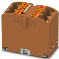
Verteilerblock, Grundklemme, Nennspannung: 450 V, Nennstrom: 24 A, Anzahl der Anschlüsse: 6, Anschlussart: Push-in-Anschluss, Querschnitt: 0,14 mm<sup>2</sup> - 4 mm<sup>2</sup>, Montageart: aufrasten auf Tragschienenadapter, Direktmontage mit Flansch, Fliegend, Farbe: braun
