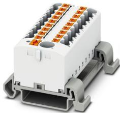
Verteilerblock, Block mit waagerechter Ausrichtung und integrierter Einspeisung, Nennspannung: 690 V, Nennstrom: 24 A, Anzahl der Anschlüsse: 19, Anschlussart: Push-in-Anschluss, Bemessungsquerschnitt: 2,5 mm<sup>2</sup>, Abgriff, Querschnitt: 0,14 mm<sup>2</sup> - 4 mm<sup>2</sup>, Push-in-Anschluss, Sammelanschluss, Bemessungsquerschnitt: 6 mm<sup>2</sup>, Querschnitt: 0,5 mm<sup>2</sup> - 10 mm<sup>2</sup>, Montageart: NS 35/7,5, NS 35/15, Farbe: weiß
