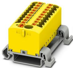
Verteilerblock, Block mit waagerechter Ausrichtung und integrierter Einspeisung, Nennspannung: 690 V, Nennstrom: 24 A, Anzahl der Anschlüsse: 19, Anschlussart: Push-in-Anschluss, Bemessungsquerschnitt: 2,5 mm<sup>2</sup>, Abgriff, Querschnitt: 0,14 mm<sup>2</sup> - 4 mm<sup>2</sup>, Push-in-Anschluss, Sammelschluss, Bemessungsquerschnitt: 6 mm<sup>2</sup>, Querschnitt: 0,5 mm<sup>2</sup> - 10 mm<sup>2</sup>, Montageart: NS 35/7,5, NS 35/15, Farbe: gelb
