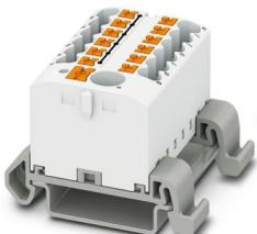
Verteilerblock, Block mit waagerechter Ausrichtung und integrierter Einspeisung, Nennspannung: 690 V, Nennstrom: 24 A, Anzahl der Anschlüsse: 13, Anschlussart: Push-in-Anschluss, Bemessungsquerschnitt: 2,5 mm<sup>2</sup>, Abgriff, Querschnitt: 0,14 mm<sup>2</sup> - 4 mm<sup>2</sup>, Push-in-Anschluss, Sammelanschluss, Bemessungsquerschnitt: 6 mm<sup>2</sup>, Querschnitt: 0,5 mm<sup>2</sup> - 10 mm<sup>2</sup>, Montageart: NS 35/7,5, NS 35/15, Farbe: weiß
