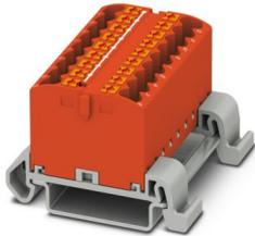
Verteilerblock, Block mit waagerechter Ausrichtung, Nennspannung: 690 V, Nennstrom: 24 A, Anzahl der Anschlüsse: 18, Anschlussart: Push-in-Anschluss, Querschnitt: 0,14 mm<sup>2</sup> - 4 mm<sup>2</sup>, Montageart: NS 35/7,5, NS 35/15, Farbe: rot
