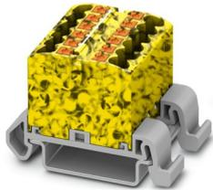
Verteilerblock, Block mit waagerechter Ausrichtung, Nennspannung: 690 V, Nennstrom: 24 A, Anzahl der Anschlüsse: 12, Anschlussart: Push-in-Anschluss, Querschnitt: 0,14 mm<sup>2</sup> - 4 mm<sup>2</sup>, Montageart: NS 35/7,5, NS 35/15, Farbe: schwarz/gelb
