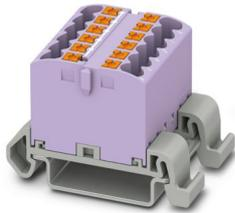
Verteilerblock, Block mit waagerechter Ausrichtung, Nennspannung: 690 V, Nennstrom: 24 A, Anzahl der Anschlüsse: 12, Anschlussart: Push-in-Anschluss, Querschnitt: 0,14 mm<sup>2</sup> - 4 mm<sup>2</sup>, Montageart: NS 35/7,5, NS 35/15, Farbe: violett
