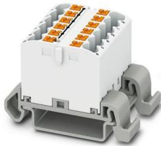
Verteilerblock, Block mit waagerechter Ausrichtung, Nennspannung: 690 V, Nennstrom: 24 A, Anzahl der Anschlüsse: 12, Anschlussart: Push-in-Anschluss, Querschnitt: 0,14 mm<sup>2</sup> - 4 mm<sup>2</sup>, Montageart: NS 35/7,5, NS 35/15, Farbe: weiß
