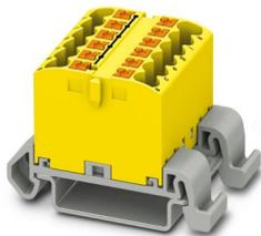
Verteilerblock, Block mit waagerechter Ausrichtung, Nennspannung: 690 V, Nennstrom: 24 A, Anzahl der Anschlüsse: 12, Anschlussart: Push-in-Anschluss, Querschnitt: 0,14 mm<sup>2</sup> - 4 mm<sup>2</sup>, Montageart: NS 35/7,5, NS 35/15, Farbe: gelb
