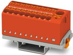
Verteilerblock, Block mit senkrechter Ausrichtung und integrierter Einspeisung, Nennspannung: 690 V, Nennstrom: 24 A, Anzahl der Anschlüsse: 19, Anschlussart: Push-in-Anschluss, Bemessungsquerschnitt: 2,5 mm<sup>2</sup>, Abgriff, Querschnitt: 0,14 mm<sup>2</sup> - 4 mm<sup>2</sup>, Push-in-Anschluss, Sammelanschluss, Bemessungsquerschnitt: 6 mm<sup>2</sup>, Querschnitt: 0,5 mm<sup>2</sup> - 10 mm<sup>2</sup>, Montageart: NS 35/7,5, NS 35/15, Farbe: rot
