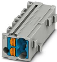
Rangierwabe, Nennspannung: 500 V, Nennstrom: 17,5 A, Anschlussart: Push-in-Anschluss, Querschnitt: 0,14 mm<sup>2</sup> - 2,5 mm<sup>2</sup>, Montage: aufrasten auf Tragschienenadapter, aufrasten auf Deckelflansch, Farbe: grau, Farbe Anschlusselemente: blau
