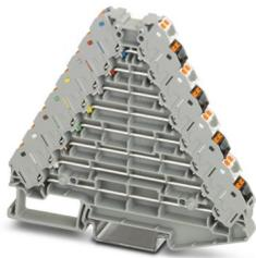
Rangierverteiler, linke Seite nach VDE 0815, rechte Seite mit weißen und schwarzen Steckfeldern, Nennspannung: 250 V, Nennstrom: 8 A, Anschlussart: Push-in-Anschluss, 1., 2., 3., 4., 5., 6., 7. und 8. Etage, Bemessungsquerschnitt: 1,5 mm<sup>2</sup>, Querschnitt: 0,14 mm<sup>2</sup> - 2,5 mm<sup>2</sup>, Montage: NS 35/7,5, NS 35/15, Farbe: grau
