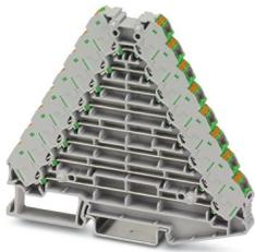
Rangierverteiler, Nennspannung: 250 V, Nennstrom: 8 A, Anschlussart: Push-in-Anschluss, 1., 2., 3., 4., 5., 6., 7. und 8. Etage, Bemessungsquerschnitt: 1,5 mm<sup>2</sup>, Querschnitt: 0,14 mm<sup>2</sup> - 2,5 mm<sup>2</sup>, Montage: NS 35/7,5, NS 35/15, Farbe: grau, Farbe Anschlusselemente: grün
