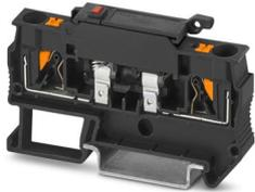
Sicherungsreihenklemme, Art der Sicherung: Glas / Keramik / ..., Sicherungstyp: G / 5 x 20, Nennspannung: 60 V, Nennstrom: 6,3 A, Anschlussart: Push-in-Anschluss, 1. Etage, Bemessungsquerschnitt: 1 mm<sup>2</sup>, Querschnitt: 0,2 mm<sup>2</sup>- 6 mm<sup>2</sup>, Montageart: NS 35/7,5, NS 35/15, Farbe: schwarz
