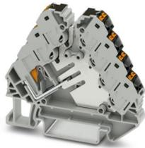
Potenzialverteiler, mit Einspeisemöglichkeit bis zu 6 mm<sup>2</sup>, Nennspannung: 250 V, Nennstrom: 17,5 A, Anschlussart: Push-in-Anschluss, Bemessungsquerschnitt: 1,5 mm<sup>2</sup>, Querschnitt: 0,14 mm<sup>2</sup> - 2,5 mm<sup>2</sup>, Einspeisetage, Bemessungsquerschnitt: 4 mm<sup>2</sup>, Querschnitt: 0,2 mm<sup>2</sup> - 6 mm<sup>2</sup>, Montage: NS 35/7,5, NS 35/15, Farbe: grau, Farbe Anschlusselemente: schwarz
