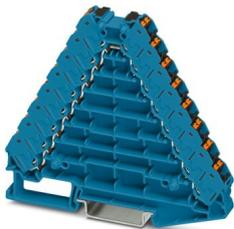
Potenzialverteiler, Nennspannung: 250 V, Nennstrom: 17,5 A, Anschlussart: Push-in-Anschluss, 1., 2., 3., 4., 5., 6., 7. und 8. Etage, Bemessungsquerschnitt: 1,5 mm<sup>2</sup>, Querschnitt: 0,14 mm<sup>2</sup> - 2,5 mm<sup>2</sup>, Montage: NS 35/7,5, NS 35/15, Farbe: blau, Farbe Anschlusselemente: schwarz
