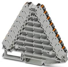
Potenzialverteiler, Nennspannung: 250 V, Nennstrom: 17,5 A, Anschlussart: Push-in-Anschluss, 1., 2., 3., 4., 5., 6., 7. und 8. Etage, Bemessungsquerschnitt: 1,5 mm<sup>2</sup>, Querschnitt: 0,14 mm<sup>2</sup> - 2,5 mm<sup>2</sup>, Montage: NS 35/7,5, NS 35/15, Farbe: grau, Farbe Anschlusselemente: schwarz
