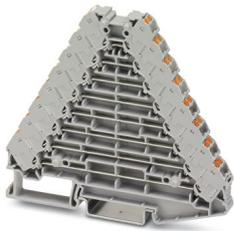
Rangierverteiler, Nennspannung: 250 V, Nennstrom: 8 A, Anschlussart: Push-in-Anschluss, 1., 2., 3., 4., 5., 6., 7. und 8. Etage, Bemessungsquerschnitt: 1,5 mm<sup>2</sup>, Querschnitt: 0,14 mm<sup>2</sup> - 2,5 mm<sup>2</sup>, Montage: NS 35/7,5, NS 35/15, Farbe: grau, Farbe Anschlusselemente: grau
