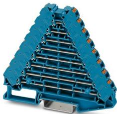
Rangierverteiler, Nennspannung: 250 V, Nennstrom: 8 A, Anschlussart: Push-in-Anschluss, 1., 2., 3., 4., 5., 6., 7. und 8. Etage, Bemessungsquerschnitt: 1,5 mm<sup>2</sup>, Querschnitt: 0,14 mm<sup>2</sup> - 2,5 mm<sup>2</sup>, Montage: NS 35/7,5, NS 35/15, Farbe: blau, Farbe Anschlusselemente: blau
