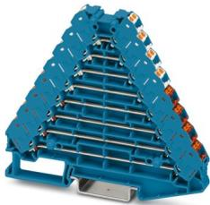
Rangierverteiler, Nennspannung: 250 V, Nennstrom: 8 A, Anschlussart: Push-in-Anschluss, 1., 2., 3., 4., 5., 6., 7. und 8. Etage, Bemessungsquerschnitt: 1,5 mm<sup>2</sup>, Querschnitt: 0,14 mm<sup>2</sup> - 2,5 mm<sup>2</sup>, Montage: NS 35/7,5, NS 35/15, Farbe: blau, Farbe Anschlusselemente: weiß, rot
