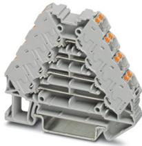
Rangierverteiler, Nennspannung: 250 V, Nennstrom: 10 A, Anschlussart: Push-in-Anschluss, 1., 2., 3. und 4. Etage, Bemessungsquerschnitt: 1,5 mm<sup>2</sup>, Querschnitt: 0,14 mm<sup>2</sup> - 2,5 mm<sup>2</sup>, Montage: NS 35/7,5, NS 35/15, Farbe: grau, Farbe Anschlusselemente: grau
