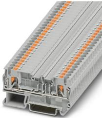
Durchgangsklemme, Nennspannung: 400 V, Nennstrom: 24 A, Anzahl der Anschlüsse: 2, Anschlussart: Push-in-Anschluss, Bemessungsquerschnitt: 2,5 mm<sup>2</sup>, 1. Etage, Querschnitt: 0,14 mm<sup>2</sup> - 4 mm<sup>2</sup>, Montageart: NS 35/7,5, NS 35/15, Farbe: grau
