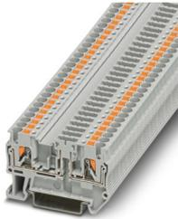
Trennklemme, Strom und Spannung werden durch den eingesetzten Stecker bestimmt., Nennspannung: 400 V, Thermischer Dauerstrom  $I_{th}$ : 20 A, Anschlussart: Push-in-Anschluss, Bemessungsquerschnitt: 2,5 mm<sup>2</sup>, Querschnitt: 0,14 mm<sup>2</sup> - 4 mm<sup>2</sup>, Montage: NS 35/7,5, NS 35/15, Farbe: grau
