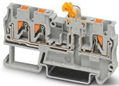
Messertrennklemme, Nennspannung: 400 V, Nennstrom: 20 A, 1. Etage, Anschlussart: Push-in-Anschluss, Bemessungsquerschnitt: 2,5 mm<sup>2</sup>, Querschnitt: 0,14 mm<sup>2</sup> - 4 mm<sup>2</sup>, Montage: NS 35/7,5, NS 35/15, Farbe: grau
