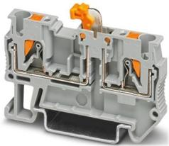
Messertrennklemme, Nennspannung: 400 V, Nennstrom: 20 A, Anschlussart: Push-in-Anschluss, Bemessungsquerschnitt: 2,5 mm<sup>2</sup>, Querschnitt: 0,14 mm<sup>2</sup> - 4 mm<sup>2</sup>, Montage: NS 35/7,5, NS 35/15, Farbe: grau
