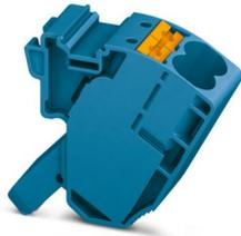
Abgriffklemme, Nennspannung: 1500 V, Nennstrom: 57 A, Anzahl der Anschlüsse: 2, Anschlussart: Push-in-Anschluss, Bemessungsquerschnitt: 10 mm<sup>2</sup>, 1. Etage, Querschnitt: 0,5 mm<sup>2</sup> - 16 mm<sup>2</sup>, Montageart: auf Basiselement, Farbe: blau
