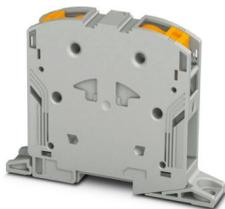
Hochstromklemme, Nennspannung: 1000 V, Nennstrom: 232 A, Anzahl der Anschlüsse: 2, Polzahl: 1, Anschlussart: PowerTurn-Anschluss, Querschnitt: 25 mm<sup>2</sup> - 95 mm<sup>2</sup>, Montageart: direktes Anschrauben, Farbe: grau
