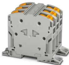
Hochstromklemme, geblockt, Nennspannung: 1000 V, Nennstrom: 232 A, Anzahl der Anschlüsse: 6, Polzahl: 3, Anschlussart: PowerTurn-Anschluss, Querschnitt: 25 mm<sup>2</sup> - 95 mm<sup>2</sup>, Montageart: direktes Anschrauben, Farbe: grau
