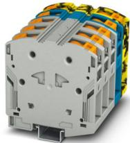
Hochstromklemme, geblockt, Nennspannung: 1000 V, Nennstrom: 232 A, Anzahl der Anschlüsse: 10, Polzahl: 5, Anschlussart: PowerTurn-Anschluss, Querschnitt: 25 mm<sup>2</sup> - 95 mm<sup>2</sup>, Montageart: NS 35/15, Farbe: grau/blau/schwarz-gelb
