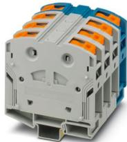
Hochstromklemme, geblockt, Nennspannung: 1000 V, Nennstrom: 232 A, Anzahl der Anschlüsse: 8, Polzahl: 4, Anschlussart: PowerTurn-Anschluss, Querschnitt: 25 mm<sup>2</sup> - 95 mm<sup>2</sup>, Montageart: NS 35/15, Farbe: grau/blau
