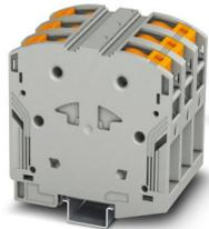
Hochstromklemme, geblockt, Nennspannung: 1000 V, Nennstrom: 232 A, Anzahl der Anschlüsse: 6, Polzahl: 3, Anschlussart: PowerTurn-Anschluss, Querschnitt: 25 mm<sup>2</sup> - 95 mm<sup>2</sup>, Montageart: NS 35/15, Farbe: grau
