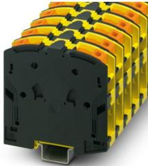
Hochstromklemme, Nennspannung: 1000 V, Nennstrom: 150 A, Anzahl der Anschlüsse: 2, Polzahl: 1, Anschlussart: PowerTurn-Anschluss, 1. Etage, Querschnitt: 10 mm<sup>2</sup> - 70 mm<sup>2</sup>, Montageart: NS 35/15, Farbe: schwarz/gelb
