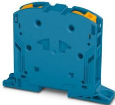
Hochstromklemme, Nennspannung: 1000 V, Nennstrom: 150 A, Anzahl der Anschlüsse: 2, Polzahl: 1, Anschlussart: PowerTurn-Anschluss, 1. Etage, Querschnitt: 10 mm<sup>2</sup> - 70 mm<sup>2</sup>, Montageart: direktes Anschrauben, Farbe: blau
