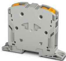
Hochstromklemme, Nennspannung: 1000 V, Nennstrom: 150 A, Anzahl der Anschlüsse: 2, Polzahl: 1, Anschlussart: PowerTurn-Anschluss, 1. Etage, Querschnitt: 10 mm<sup>2</sup> - 70 mm<sup>2</sup>, Montageart: direktes Anschrauben, Farbe: grau
