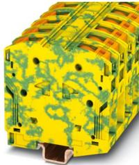
Schutzleiter-Reihenklemme, Anzahl der Anschlüsse: 2, Polzahl: 1, Anschlussart: PowerTurn-Anschluss, 1. Etage, Querschnitt: 10 mm<sup>2</sup> - 70 mm<sup>2</sup>, Montageart: NS 35/15, Farbe: grün-gelb
