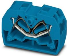
Doppel-Mini-Flanschklemm, Nennspannung: 800 V, Nennstrom: 24 A, Anzahl der Anschlüsse: 4, Anschlussart: Zugfederanschluss, Bemessungsquerschnitt: 2,5 mm<sup>2</sup>, 1. Etage, Querschnitt: 0,08 mm<sup>2</sup> - 4 mm<sup>2</sup>, Montageart: direktes Anschrauben, Farbe: blau
