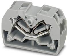
Doppel-Mini-Flanschklemm, Nennspannung: 800 V, Nennstrom: 24 A, Anzahl der Anschlüsse: 4, Anschlussart: Zugfederanschluss, Bemessungsquerschnitt: 2,5 mm<sup>2</sup>, 1. Etage, Querschnitt: 0,08 mm<sup>2</sup> - 4 mm<sup>2</sup>, Montageart: direktes Anschrauben, Farbe: grau
