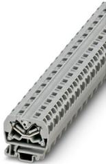
Minidurchgangsklemme, Nennspannung: 800 V, Nennstrom: 24 A, Anzahl der Anschlüsse: 4, Anschlussart: Zugfederanschluss, Bemessungsquerschnitt: 2,5 mm<sup>2</sup>, 1. Etage, Querschnitt: 0,08 mm<sup>2</sup> - 4 mm<sup>2</sup>, Montageart: NS 15, Farbe: grau
